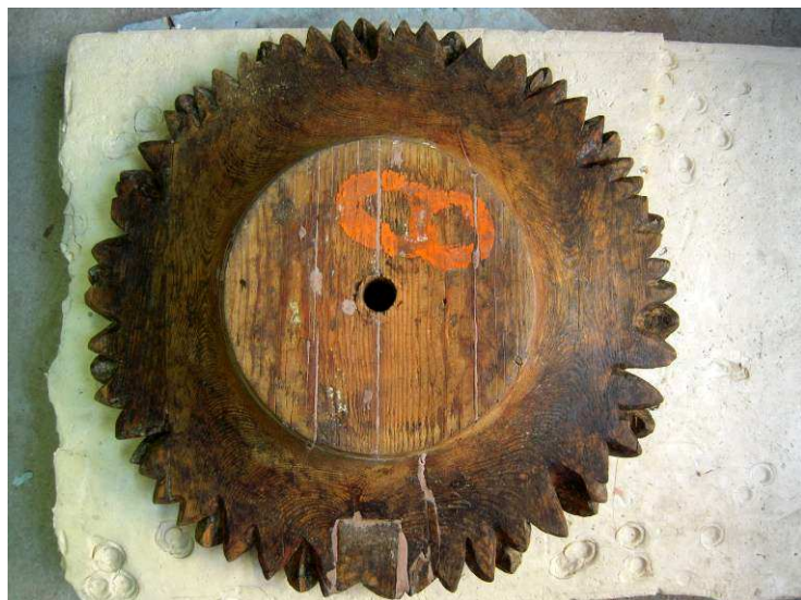
Vista posterior tras el sellado de las fendas y la Limpieza
